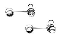
插入数据采集棒,再沿顺时针方向拧紧浮动螺 母,如下图所示。
